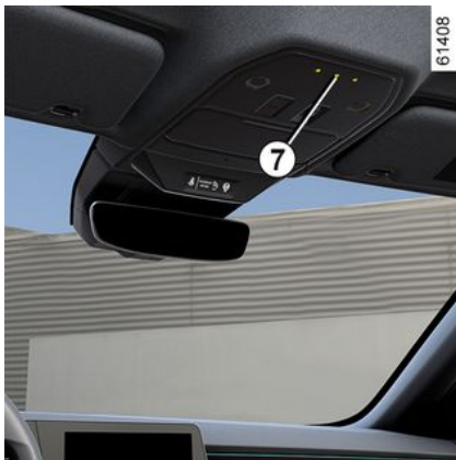
Mikrofon 7 (för telefonen och röstvägledningssystemet)
